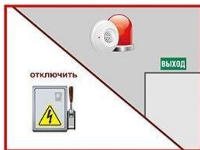
Обесточить здание. Проверить включение в работу автоматических систем пожаротушения.
